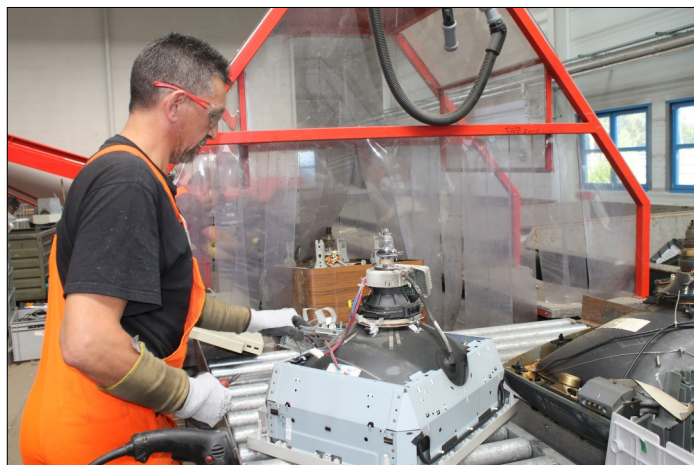
Von den Röhrenfernsehgeräten werden die Gehäuse entfernt
