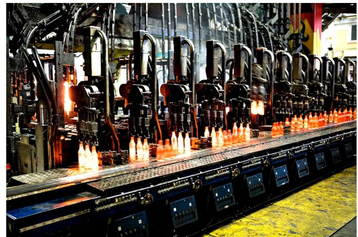
**Aus dem flüssigen Glas formen Maschinen Glasbehälter, die vor Hitze orangefarben glühen.**
