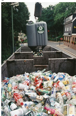
Der Inhalt der drei Glasbehälter (weiss, braun und grün) wird in einen einzigen LKW gekippt. Dieser hat aber im Inneren drei getrennte Kammern. Foto: Der Grüne Punkt, DSD Deutschland GmbH
