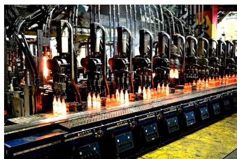
Aus dem flüssigen Glas formen Maschinen Glasbehälter, die vor Hitze orangerot glühen.
