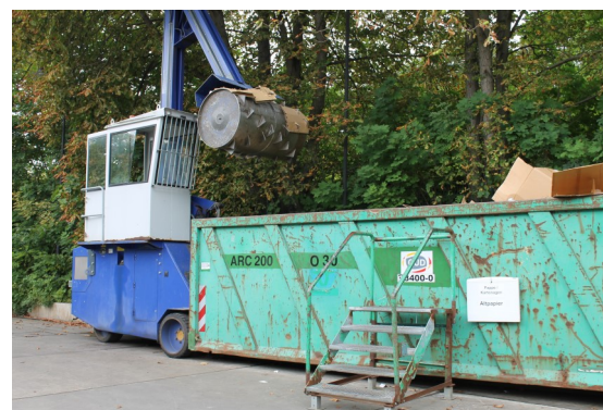
Ein Rollbagger verdichtet platzsparend u.a. Pappe und Kartonagen. Foto: AWW
