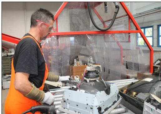
Fa. Becker Elektrorecycling: Von Röhrenfernsehgeräten werden die Gehäuse entfernt
