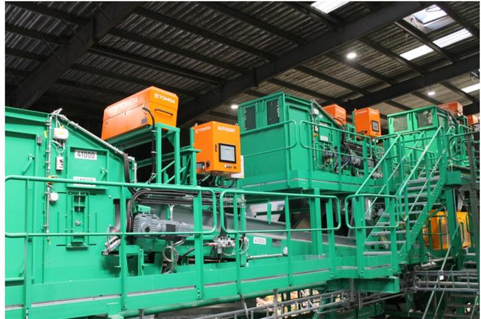
Neue moderne Sortiereinrichtung für die Trennung von Nichteisenbestandteilen, Folien und Verbundverpackungen und unterschiedlichen Kunststoffarten
