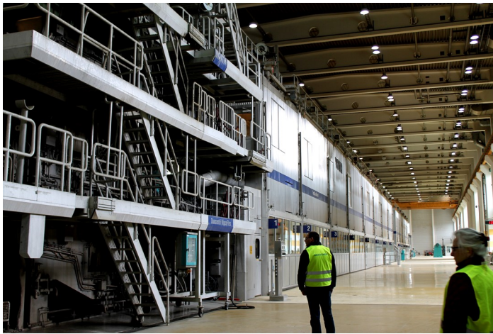
Gewaltige Dimensionen: Die Papiermaschine des Unternehmens Jass hat eine Länge von 160 m, die Breite der Papierbahn beträgt 7,50 m
